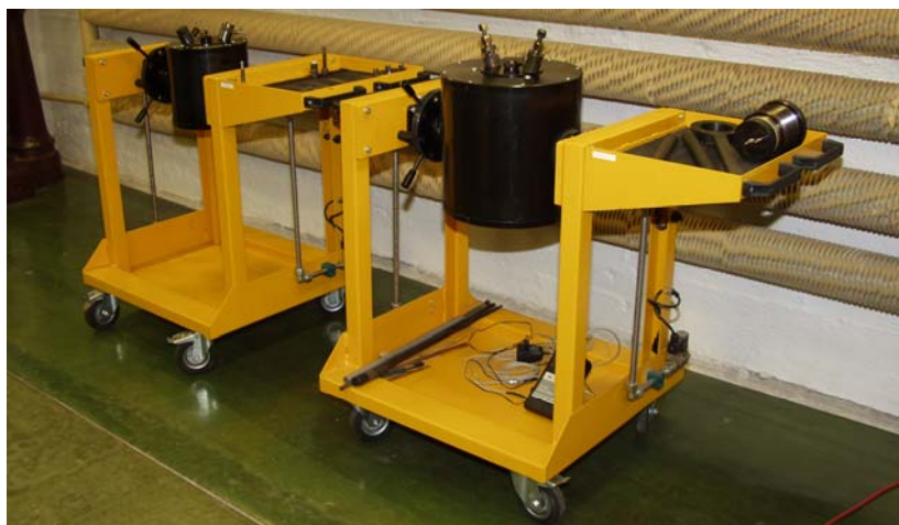
Fot. 17. Stanowiska badawcze do wyznaczenia charakterystyk energetyczno-balistycznych stałych materiałów miotających z komorami manometrycznym o objętości 200 i 700 cm 3
