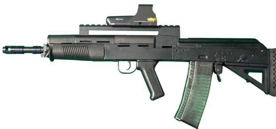
Fot.13. Model badawczy 5,56 mm karabinka bezkolbowego wz.2005 JANTAR-M, będący wynikiem pracy naukowo-badawczej finansowanej przez Ministerstwo Edukacji i Nauki pt. „Analiza i synteza konstrukcyjno-balistyczna oraz badania dynamiczne broni strzeleckiej zbudowanej w układzie bezkolbowym”
