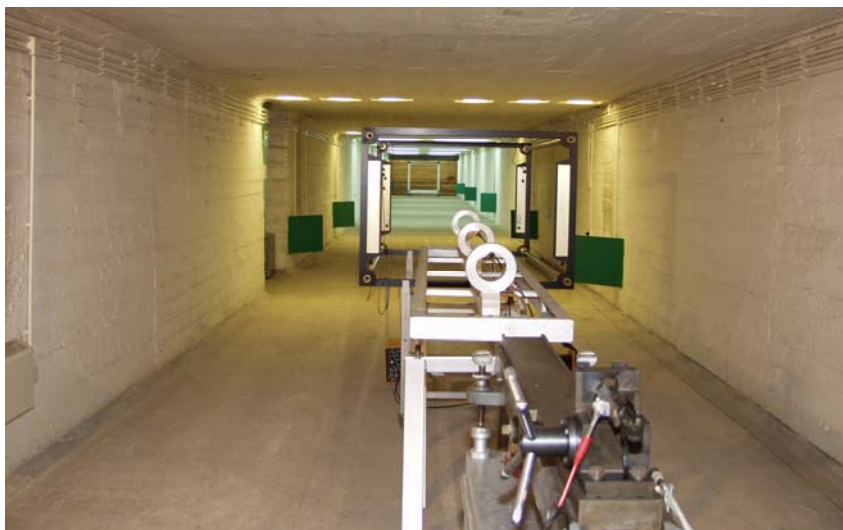
Fot.8 Tunel strzelecki w Laboratorium Balistyki z aparaturą do pomiaru charakterystyk balistycznych broni i amunicji
