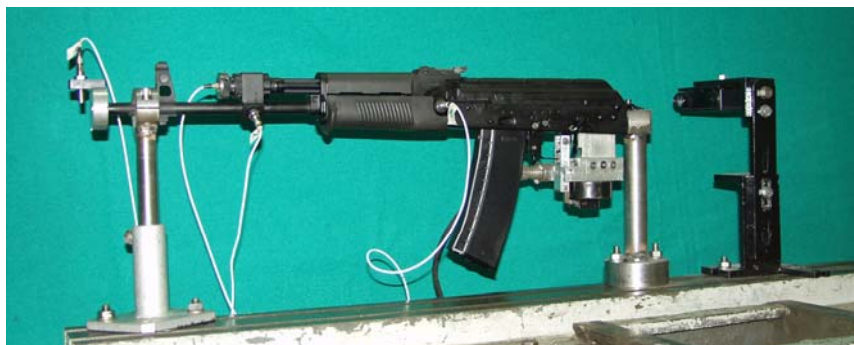
Fot.16. Stanowisko badawcze do badania węzła gazowego typ 5,56B i charakterystyk dynamicznych broni
