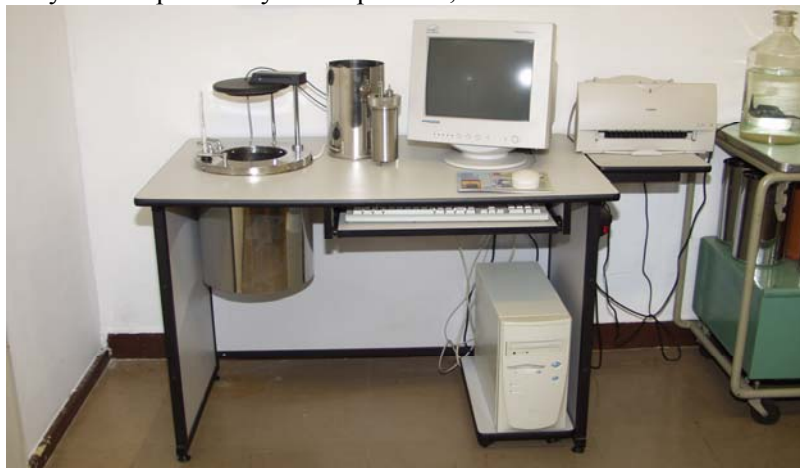
Fot.18. Stanowisko badawcze do wyznaczania ciepła spalania stałych materiałów miotających i napędowych
