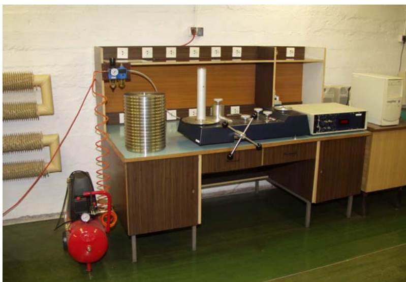
Fot. 19. Stanowiska do statycznej kalibracji piezoelektrycznych przetworników ciśnienia
