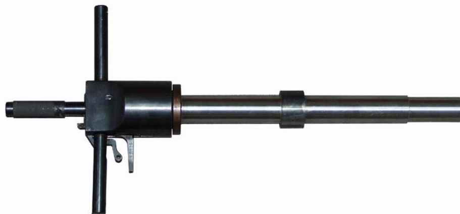
Fot.12. Model badawczy dwukomorowego układu miotającego do granatnika kalibru 23
