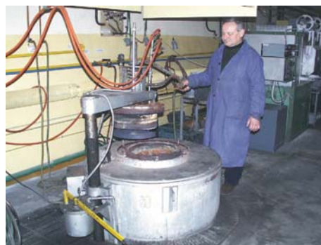
Piec węglowy do obróbki cieplnej
