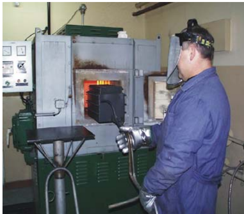
Piec do wyżarzania redukującego spieki ciężkie
