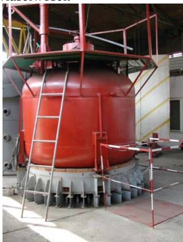
Komora wybuchowa o objętości 7 m 3 (z lewej) oraz zestaw do pomiaru ciepła detonacji materiałów wysokoenergetycznych (z prawej)
