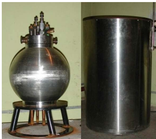
Komora wybuchowa o objętości 7 m 3 (z lewej) oraz zestaw do pomiaru ciepła detonacji materiałów wysokoenergetycznych (z prawej)
