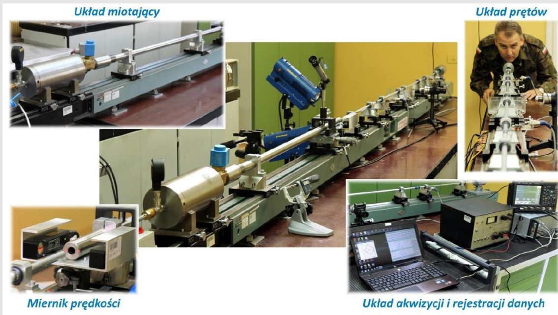
Fot. Stanowisko dzielonego pręta Hopkinsona do określania współczynników modeli konstytutywnych
