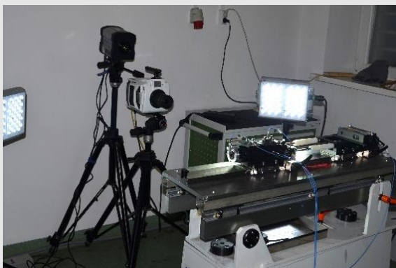
Fot. Stanowisko do badań dynamicznych i cieplnych broni strzeleckiej
