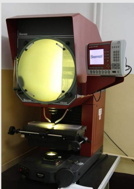
Fot. Projektor pomiarowy VB400
