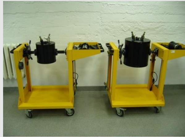
Fot. Komory manometryczne B-180 o objętościach 200 cm 3 i 700 cm 3 do badań pirostatycznych stałych materiałów miotających
