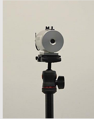
Fot. Stanowisko do pomiarów szybkostrzelności broni automatycznej
