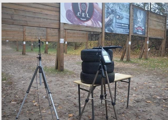
Fot. Stanowisko do badań poziomu dźwięku broni strzeleckiej
