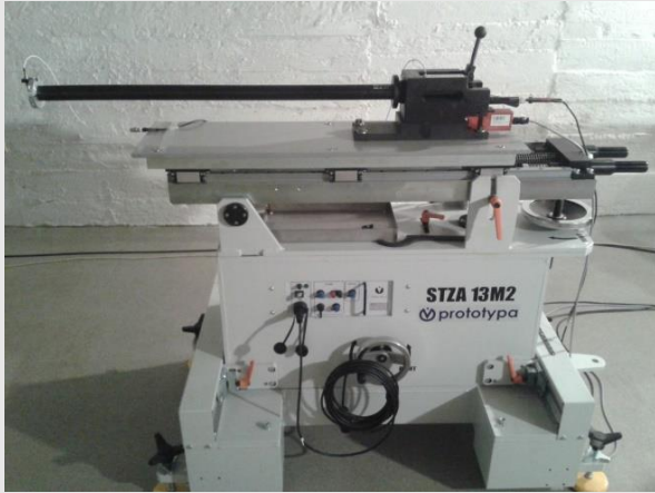
Fot. Stanowisko do pomiarów ciśnienia gazów prochowych w przestrzeni zapociskowej przewodu lufy
