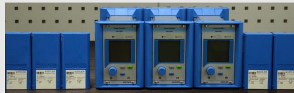
Fot. Zestaw przetworników Kistler 6215 i 6213 oraz wzmacniacze ładunków do mierzenia ciśnienia w broni palnej i lufach balistycznych
