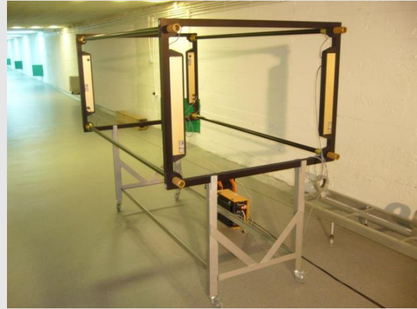
Fot. Stanowisko do wyznaczania prędkości pocisków strzeleckich na torze lotu – układ B-470
