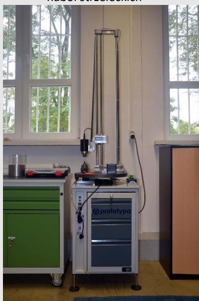
Fot. Stanowisko badawcze PST do badania spłonek i zapłonników
