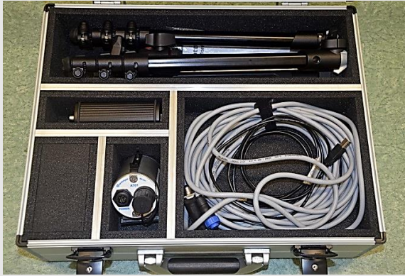
Fot. Stanowisko do pomiarów szybkostrzelności broni automatycznej
