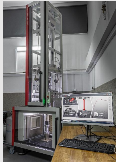
Fot. Młot opadowy Zwick/Roell Amsler Hit 2000F
