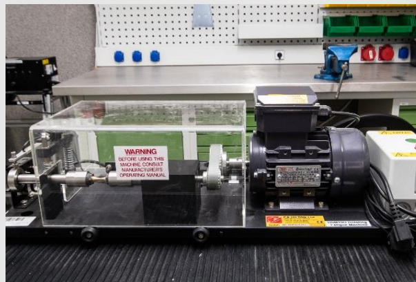
Fot. Stanowisko do badań wytrzymałości zmęczeniowej HSN 19D
