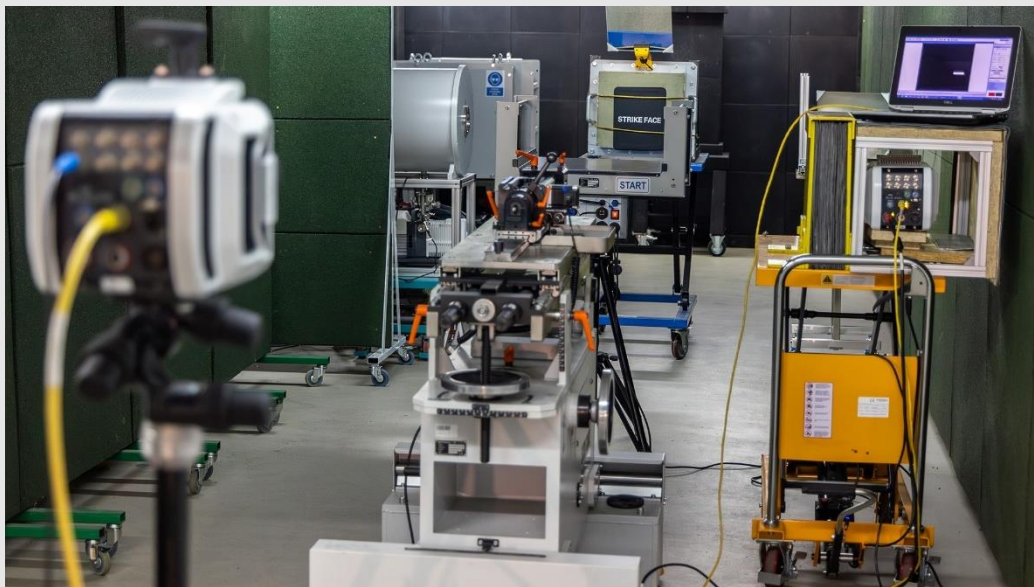
Fot. Stanowisko do badań zjawisk balistyki końcowej z wykorzystaniem układu kamer do zdjęć szybkich oraz rentgenografii impulsowej
