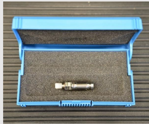
Fot. Przetwornik ciśnienia Kistler 6215
