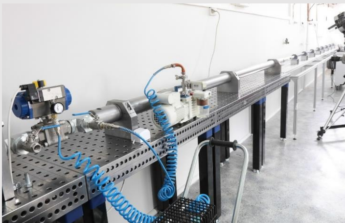
Fot. Stanowisko dzielonego pręta Hopkinsona do badań właściwości struktur energochłonnych
