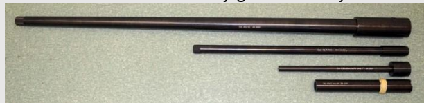
Fot. Lufy balistyczne (ciśnieniowe, prędkościowe, skupieniowe, CIP i EPVAT) do badania amunicji kalibru od 4,6 do 23 mm
