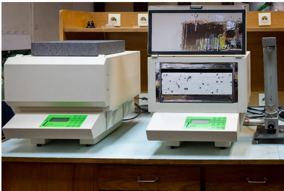
Rys. 11. Profesjonalne aparaty do pomiaru współczynnika przewodzenia ciepła materiałów izolacyjnych firmy LaserComp FOX300HT (zakres temperatury od 20°C do 200°C) oraz FOX314 (20°C do 90°C) z próbką materiału izolacyjnego umieszczoną w komorze pomiarowej.
