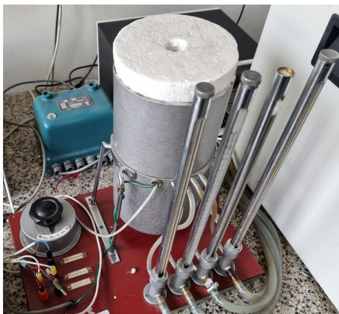
Rys. 6. Stos pomiarowy stanowiska z osłoną. Widoczny przełącznik obrotowy punktów pomiarowych i termostat.
