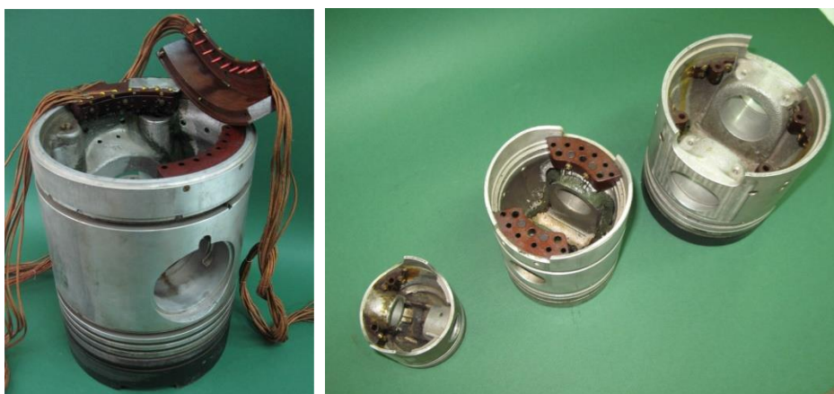
Rys. 7. Tłoki silników 8C22, PF 125p, Leyland SW680 i Wola h6 przygotowane do pomiarów temperatury
