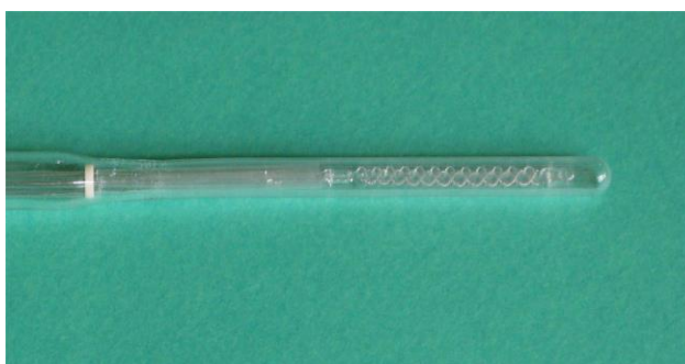
a) Platyna napyłona na płytkę ceramiczną b) Spirala z drutu platynowego nawinięta na karkas szklany
