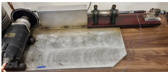
Rys.11 Elementy stanowiska laboratoryjnego do symulacji ruchu posuwisto zwrotnego tłoka
