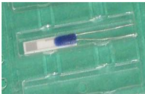
a) Platyna napyłona na płytkę ceramiczną b) Spirala z drutu platynowego nawinięta na karkas szklany
