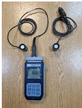
Rys. 7 Foto-Radiometr HD-2102.2 z sondą LP 471 – PHOT. Obok leży sonda LP 471-RAD do pomiaru gęstości strumienia ciepła
