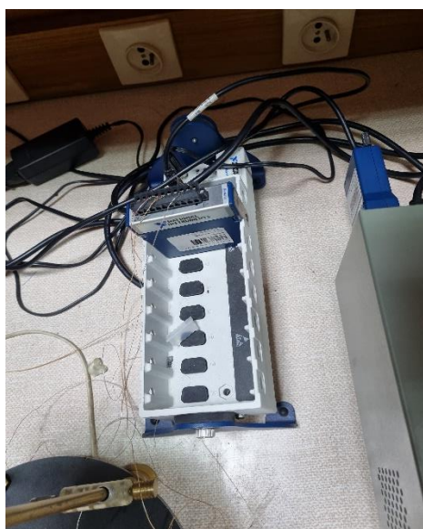
Rys. 3. a) Widok slotu NI 9172 z kartą termoparową NI 9211. b) Widok zespołu NI SCXI1100 z kartą termoparową NI 1600 i modulem do podłączenia 8 termopar.
