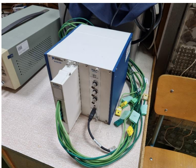
Rys. 3. a) Widok slotu NI 9172 z kartą termoparową NI 9211. b) Widok zespołu NI SCXI1100 z kartą termoparową NI 1600 i modulem do podłączenia 8 termopar.
