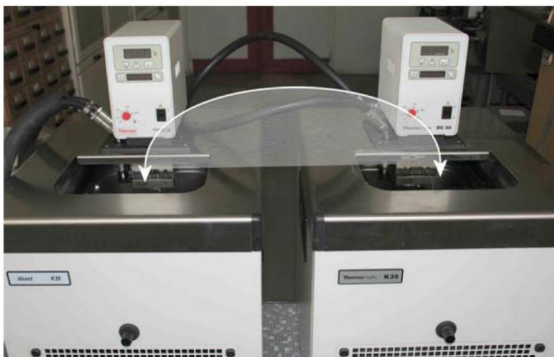
Rys. 5. Widok łaźni termostatów (ilustracja sposobu wykonywania badań)
