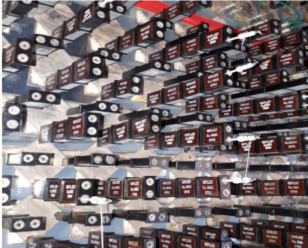
Rys. 11.3 Fragment siatki analogowego modelu typu siatka rezystorów
