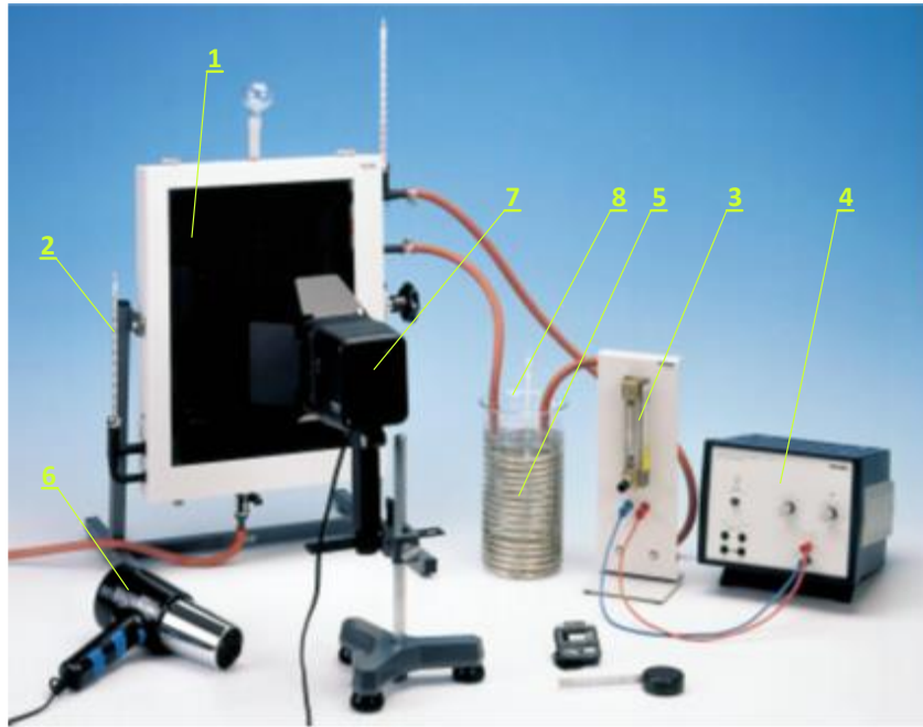
Rys. 3 Zasadnicze elementy wyposażenia stanowiska do badania płaskiego kolektora
