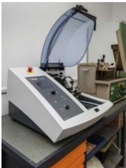
Precyzyjna zmotoryzowana przecinarka Secotom-50 firmy Struers
