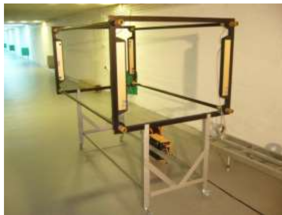
Fot. Stanowisko do wyznaczania prędkości pocisków strzeleckich na torze lotu – bariera optoelektroniczna B-470
