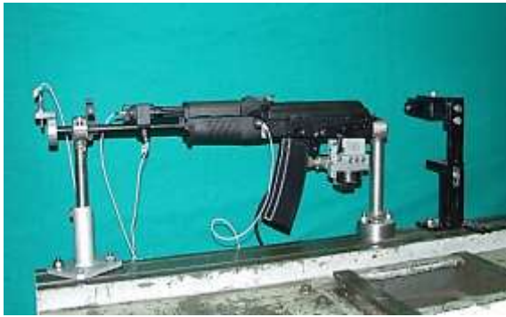
Fot. Stanowisko do badania węzła gazowego 5,56 mm kbk Beryl
