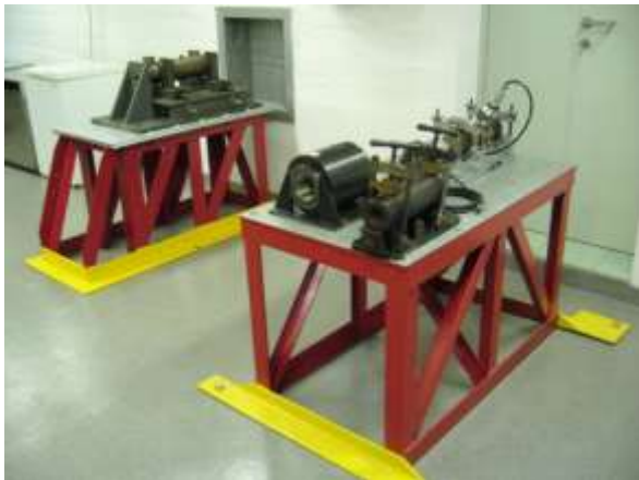
Fot. Stanowiska do pomiarów ciśnienia gazów w komorach spalania laboratoryjnych silników raketowych i ciągu raketowego
