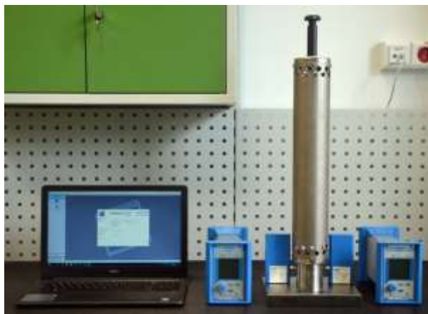
Fot. Stanowisko do kalibracji dynamicznej przetworników ciśnienia firmy Kistler
