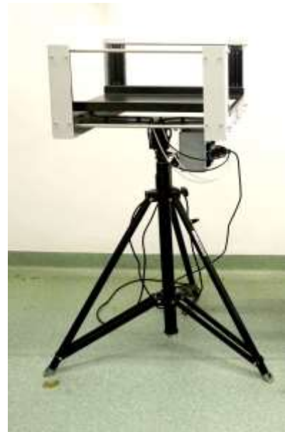
Fot. Stanowisko do pomiaru prędkości pocisku za pomocą bramek optycznych
