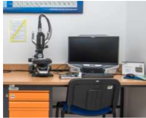
Cyfrowy mikroskop pomiarowy firmy Keyence
