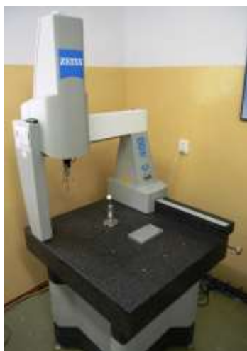
Współrzędnościowa maszyna pomiarowa C400
