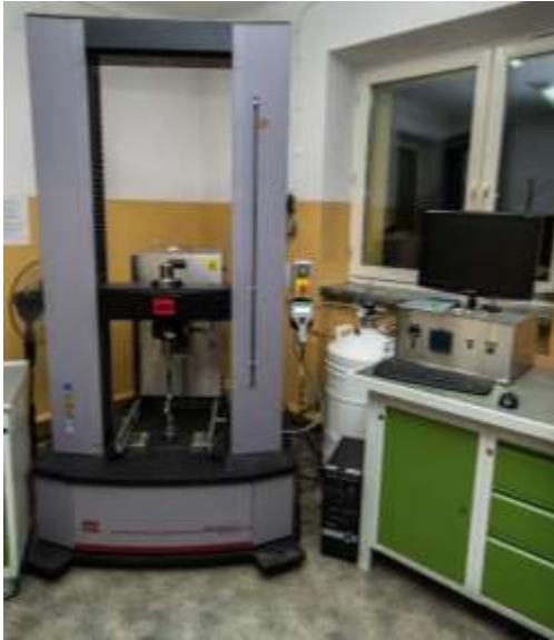
Maszyna wytrzymałościowa MTS Criterion C45
