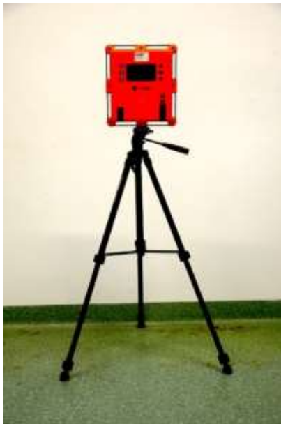
Fot. Stanowisko do pomiaru prędkości pocisku za pomocą radaru balistycznego
