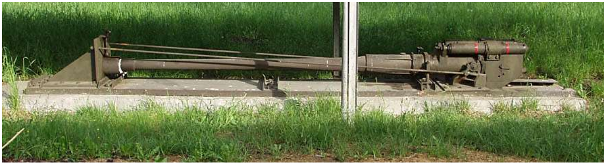
Fot. Stanowisko do badania oporopowrotnika
