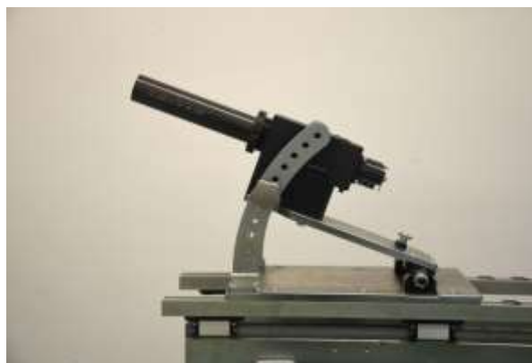
Fot. Stanowisko badawcze UZ-2011_40 do badania amunicji granatnikowej
