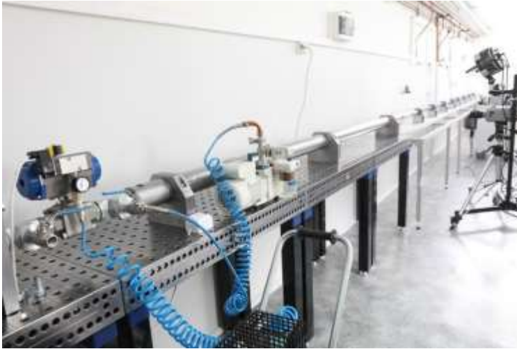
Stanowisko dzielonego pręta Hopkinsona do badań właściwości struktur energochłonnych
