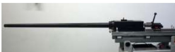
Fot. Stanowisko badawcze UZ-2010 do badania amunicji od 12,7 do 23 mm
