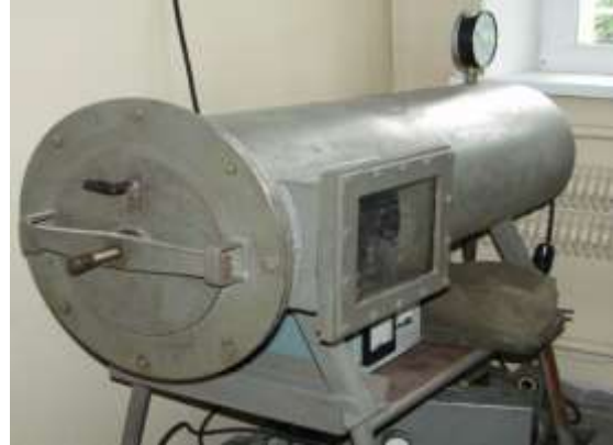
Fot. Stanowisko do badania czasu palenia ścieżek pirotechnicznych w różnych warunkach atmosferycznych
