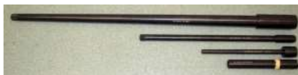
Fot. Lufy balistyczne (ciśnieniowe, prędkościowe, skupieniowe, CIP i EPVAT) do badania amunicji od 4,6 do 23 mm
