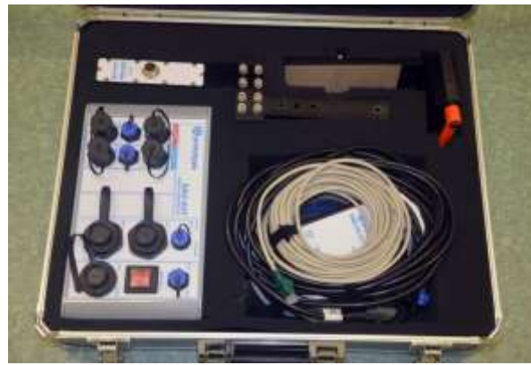
Fot. Urządzenie do pomiaru prędkości wylotowej pocisku
