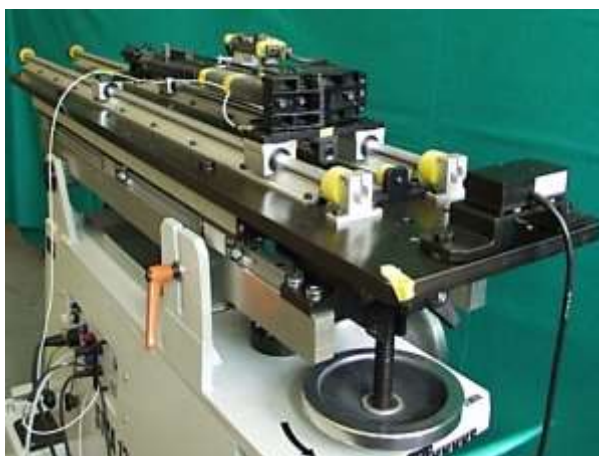
Fot. Stanowisko do pomiaru parametrów odrzutu i podrzutu broni strzeleckiej
