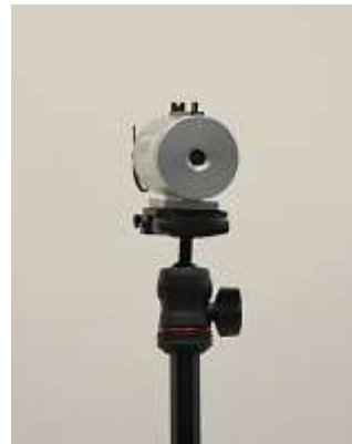
Fot. Stanowisko do pomiarów szybkostrzelności broni automatycznej
