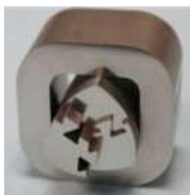
Przykładowe elementy wytworzone technologią elektroerozyjnego drażenia drutowego
