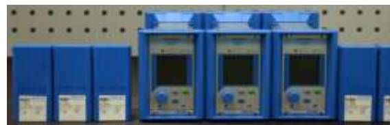
Fot. Zestaw przetworników Kistler 6215 i 6213 i wzmacniacze ładunków do mierzenia ciśnienia w broni palnej i lufach balistycznych
