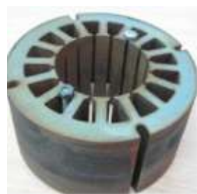
Przykładowe elementy wytworzone technologią elektroerozyjnego drażenia drutowego
