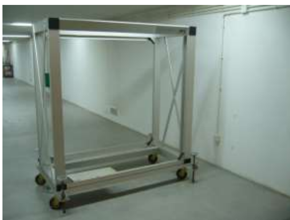
Fot. Stanowisko do wyznaczania prędkości i skupienia pocisków strzeleckich – bariera optoelektroniczna B-571
