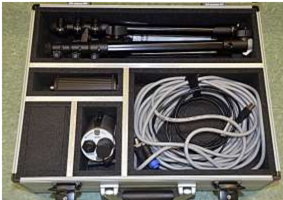
Fot. Stanowisko do pomiarów szybkostrzelności broni automatycznej
