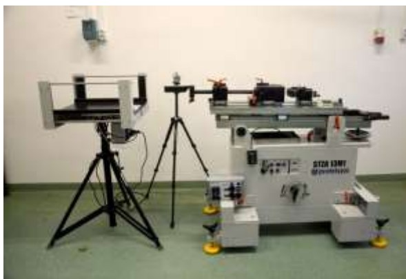
Fot. Stanowisko badawcze UZ-2002 do badania amunicji strzeleckiej
