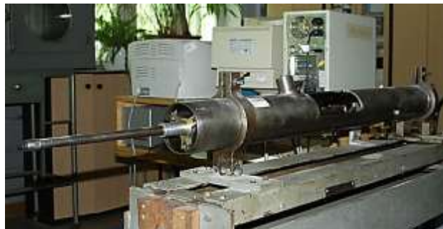
Fot. Stanowisko do badania efektywności hamulców wylotowych
