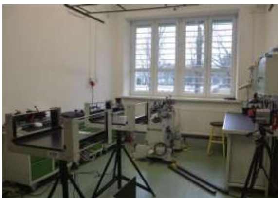
Fot. Stanowisko do badań dynamicznych i cieplnych broni strzeleckiej
