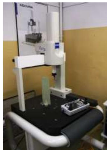
Współrzędnościowa maszyna pomiarowa Vista
