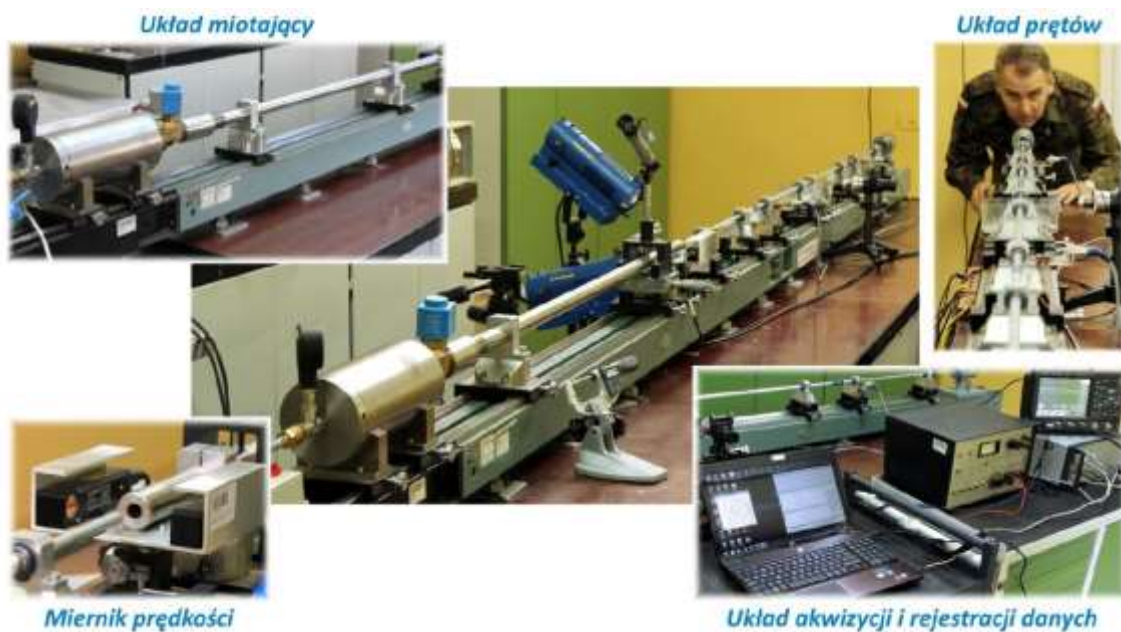
Stanowisko dzielonego pręta Hopkinsona do określania współczynników modeli konstytutywnych
