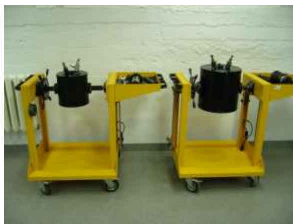
Fot. Komory manometryczne B-180 o objętościach 200 cm 3 i 700 cm 3 do badań pirostatycznych stałych materiałów miotających
