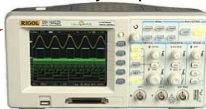
Rys. 12. Widok płyty czołowej stanowiska laboratoryjnego do badania sygnałów elektrycznych za pomocą oscyloskopu cyfrowego
