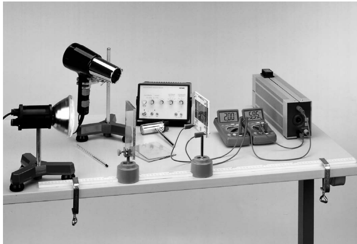
Rys. 4. Stanowisko doświadczalne do wyznaczania charakterystyk ogniwa słonecznego [1, 2].
