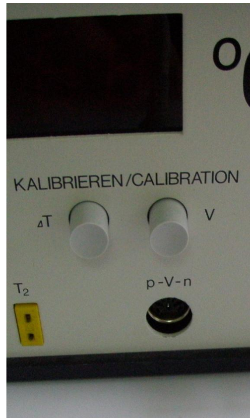
Rys. 15. Przyciski „ \Delta T ” i „V” na bloku pomiarowym firmy PHYWE
