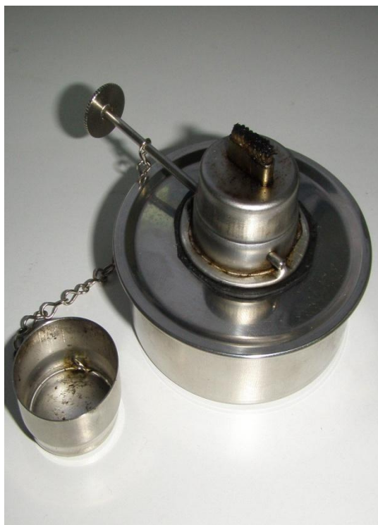
Rys. 17 Palcik spirytusowy z wysuniętym knotem oraz z pokrętkiem do jego regulacji
