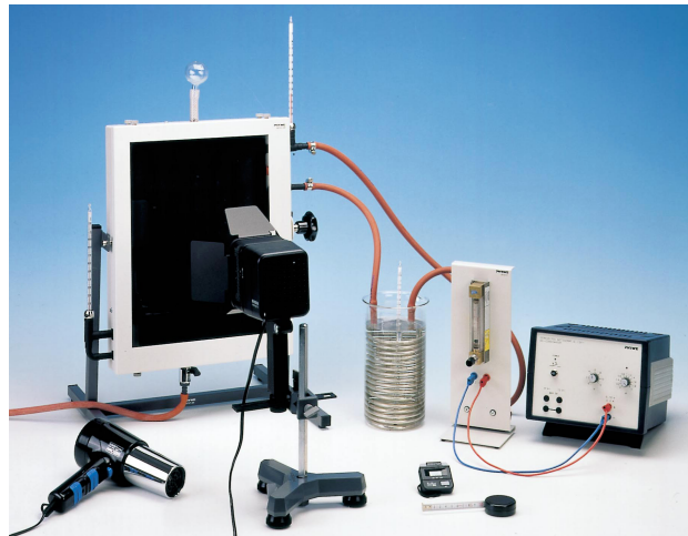
Rys. 2. Zasadnicze elementy wyposażenia stanowiska do badania płaskiego kolektora słonecznego [1, 2]:
