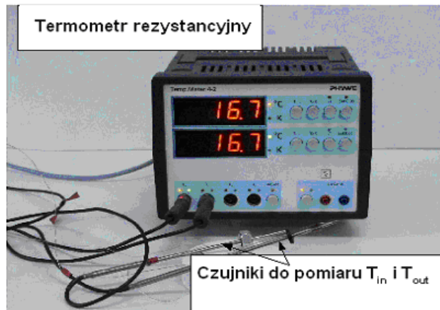
Rys. 3. Widok termometru rezystancyjnego z dwoma czujnikami Pt do pomiaru temperatury na wlocie i wylocie z kolektora słonecznego [1, 2].
