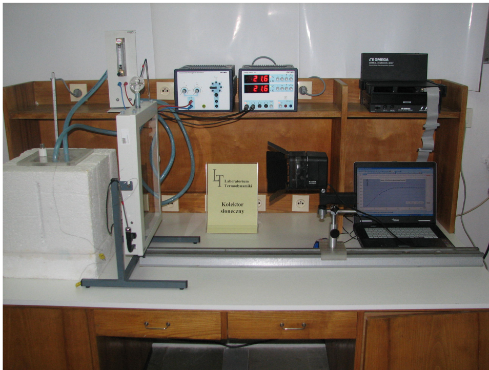
Rys. 8. Stanowisko doświadczalne do wyznaczania charakterystyk płaskiego kolektora słonecznego [1÷4].
